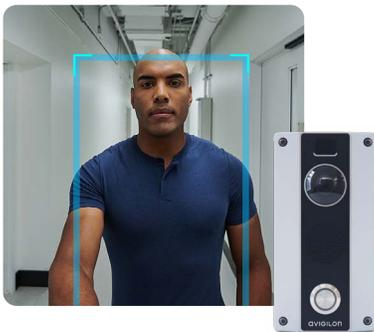
Con el software ACM™ y ACC™, usted puede verificar instantáneamente si una persona que aparece presentando una tarjeta en la cámara coincide con la foto de identificación asociada con la tarjeta de acceso que usa, y luego cerrar o abrir la puerta desde su tablero de ACC.
